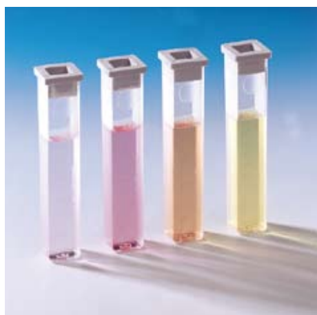
Plastové kyvety, na dvou stranách matné, objem 10 ml, 13,5 mm hloubka průhledu, s víčkem Obj.č. 14 55 00 – balení s 10 kyvetami 14 55 10 – balení se 100 kyvetami
