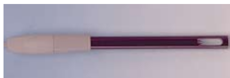
Vodivá měřící cela, 4 pólou technologie
